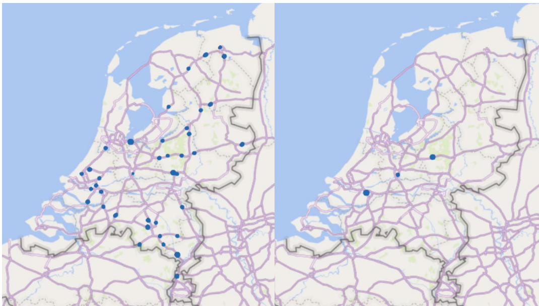
Figuur 13: laadstations TEN-T; links minimaal 600 kW vermogen en minimaal 1 lader van 300 kW of meer, rechts laadstations met minimaal 900 kW vermogen en minimaal 2 laders van 350 kW of meer (bron data RVO, data per 18 april 2022)
