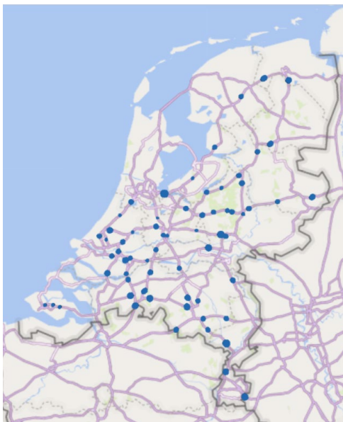
Figuur 12: laadstations verzorgingsplaatsen TEN-T met meer dan 600 kW vermogen en minimaal 2 laders van 150 kW of hoger (bron data RVO, data per 18 april 2022)
