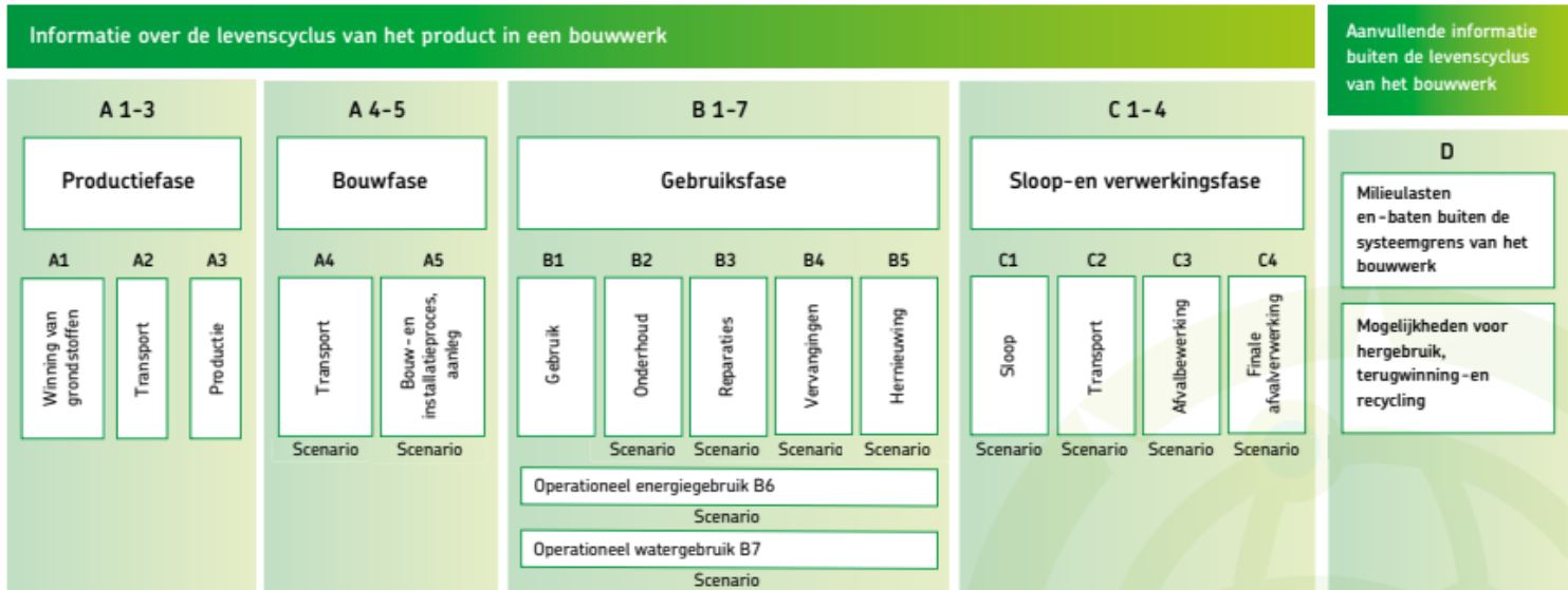
Figuur 3-7: Overzicht bouwcyclus (modules en submodules EN15804)
