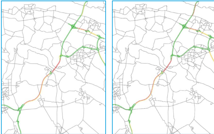
Figuur 3: I/C-verhoudingen ochtendspits (links) en avondspits (rechts) op basis van NRM-oost 2018 (basisjaar)
