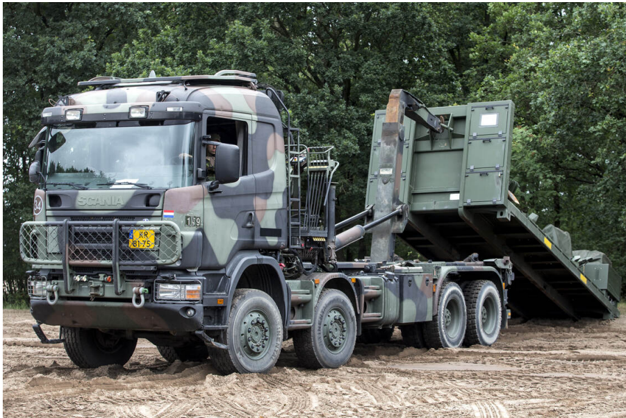
Afbeelding 2 Een vrachtwagen met flatrack. Dit is een open laadplatform zonder de zijwanden en het dak. Het is bedoeld voor deelevering van zware, afwijkende ladingen en pallets (bron: Defensie).
