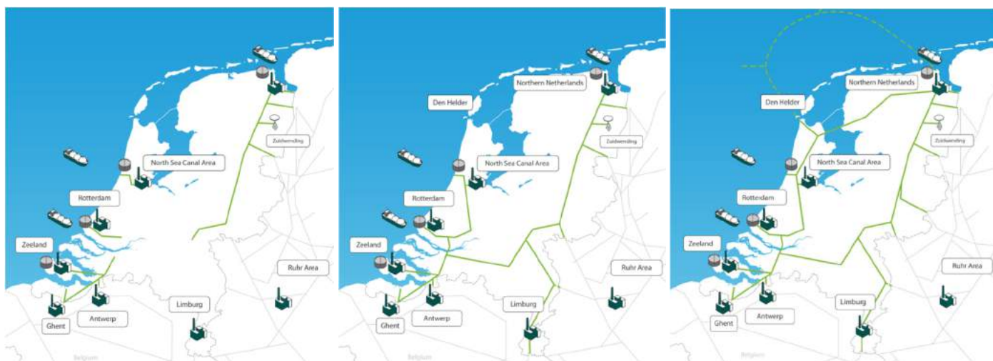
Figuur 5-2 Overzicht en fasering van het landelijk waterstofnetwerk. Links:2025-2027, Midden:2028-2029, Rechts:2030 en verder. Bron: (HyNetwork Services, 2023)
