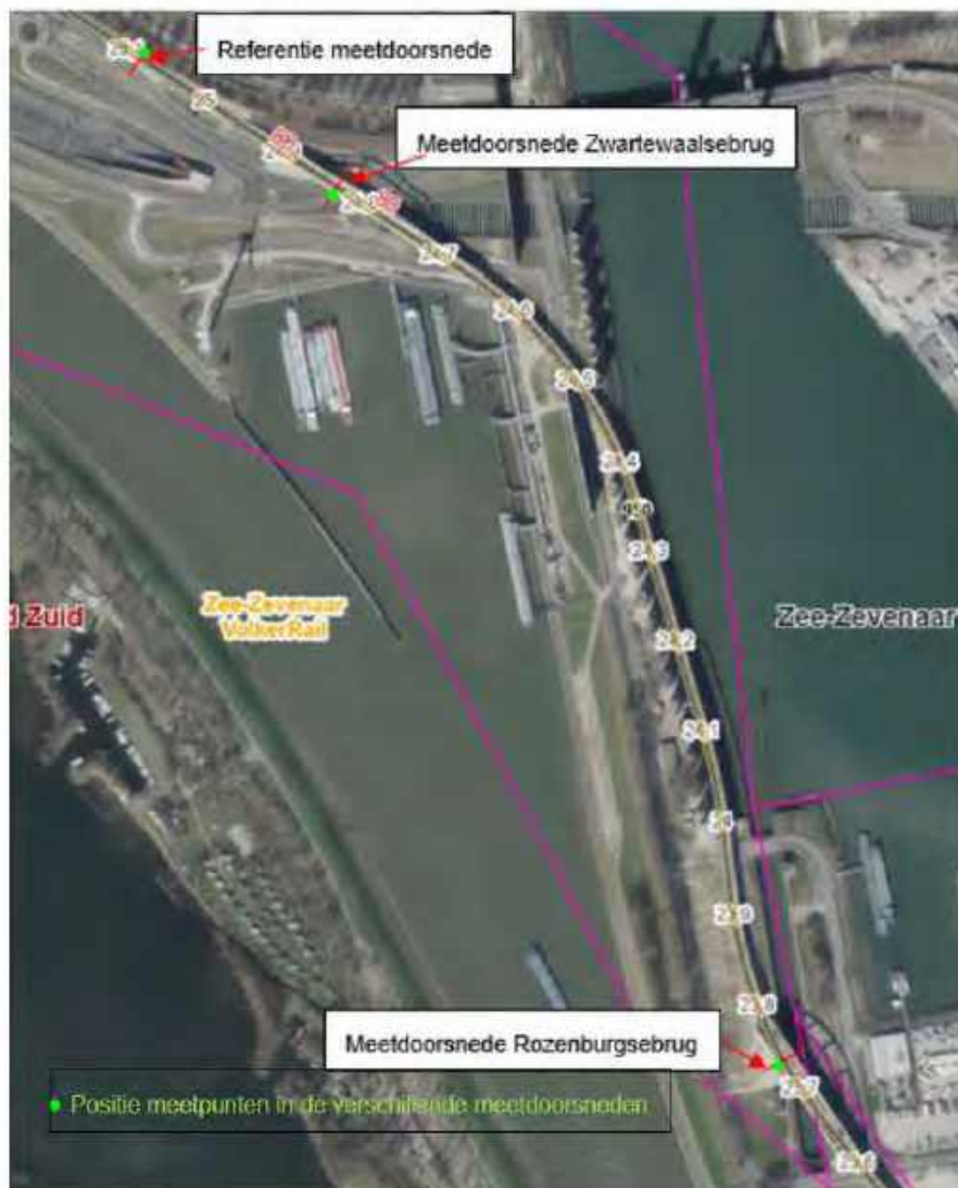
Figuur 1: Posities van de meetdoorsneden in het spoor van en naar de Maasvlakte.
