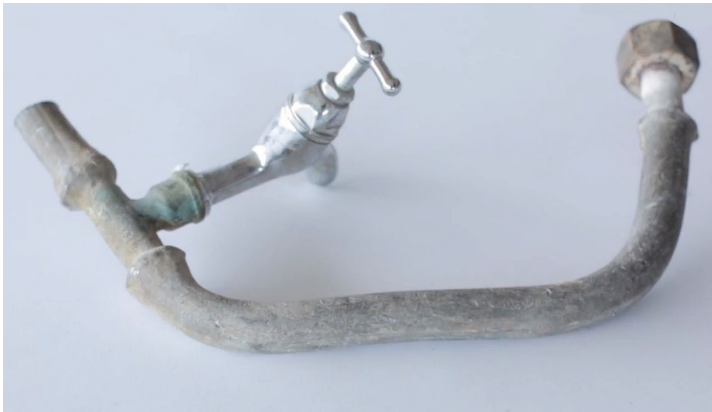
Figuur 3: Loden leiding (bron: Drinkwaterplatform)
