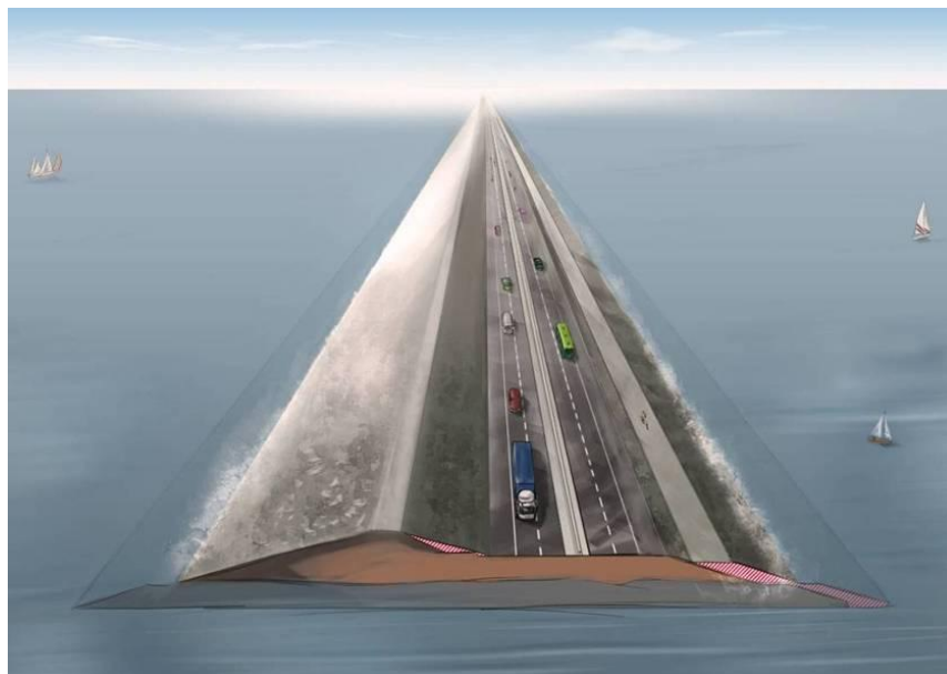
Figuur 4.4 Basisalternatief (Ba): illustratie doorsnede en beeld van de overslagbestendige dijk
