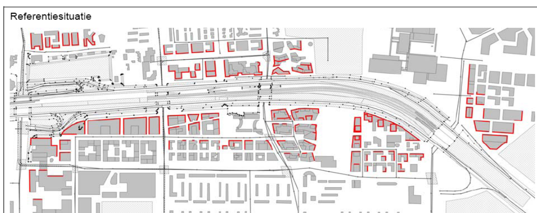
Figuur 3 Gevels in de referentiesituatie met een belasting van meer dan 53 dB als gevolg van de A10
