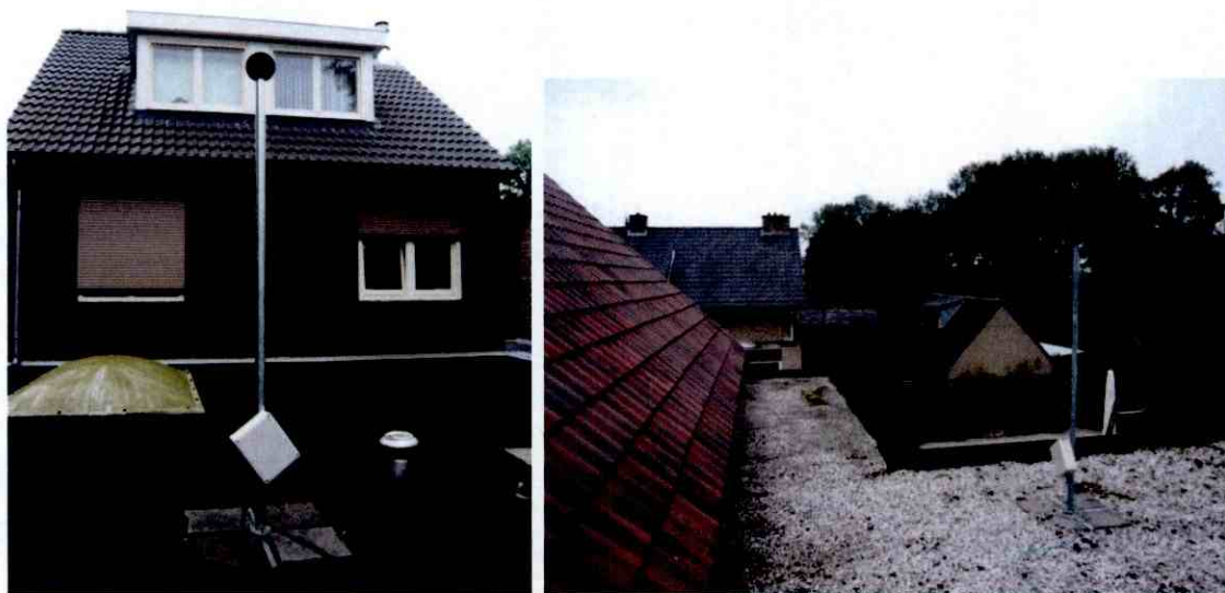
Figuur 15 – Voorbeelden van afscherming en reflectieve oppervlakken in de directe omgeving van microfoons
