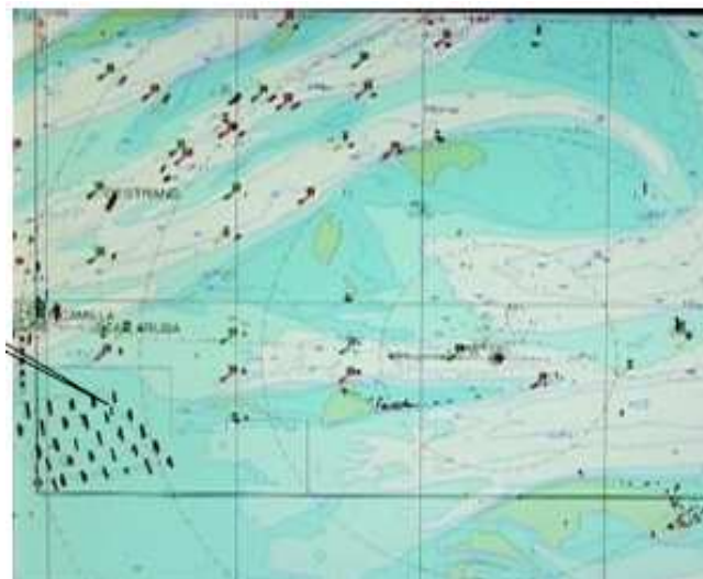
Figuur 44. Nog een voorbeeld van een schip, in het windpark (A), dat zichtbaar blijft op een scheepsradar
