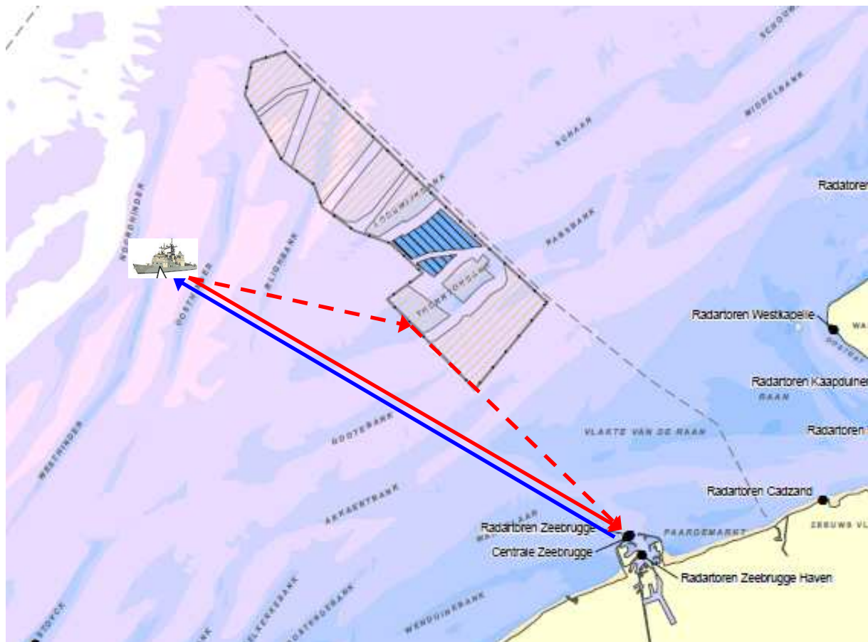
Figuur 38. Principeschets van multipath door reflectie op een windturbine (vb. bij C-Power windpark)
