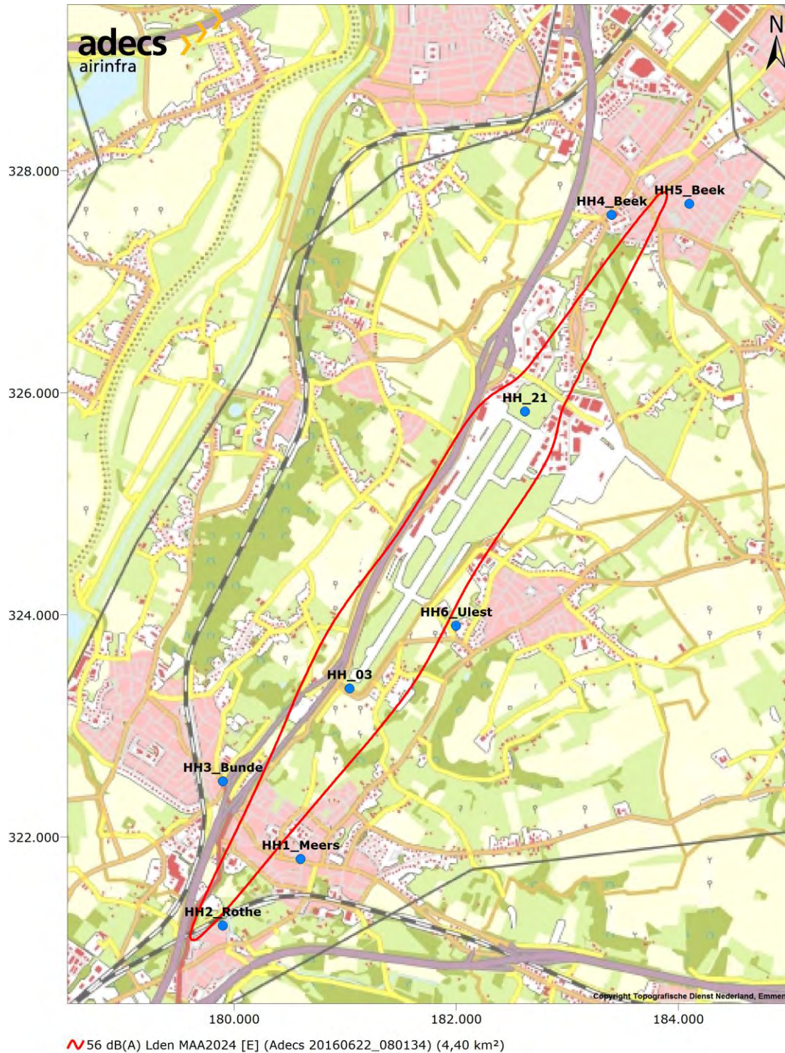
Figuur 18 Ligging van de handhavingspunten ten opzichte van de 56 dB(A) L den -contour voor de LHB-situatie MAA-2024.
