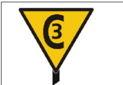
Bord RS334, Deze geeft opdracht aan de machinist van goederentreinen om af te remmen naar (in dit geval) 30 km/u.
