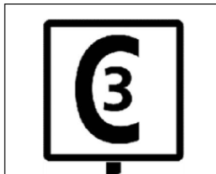
Bord RS335, Bij dit bord dient de goederentrein de doelsnelheid (van 30 km/u) te hebben bereikt.
