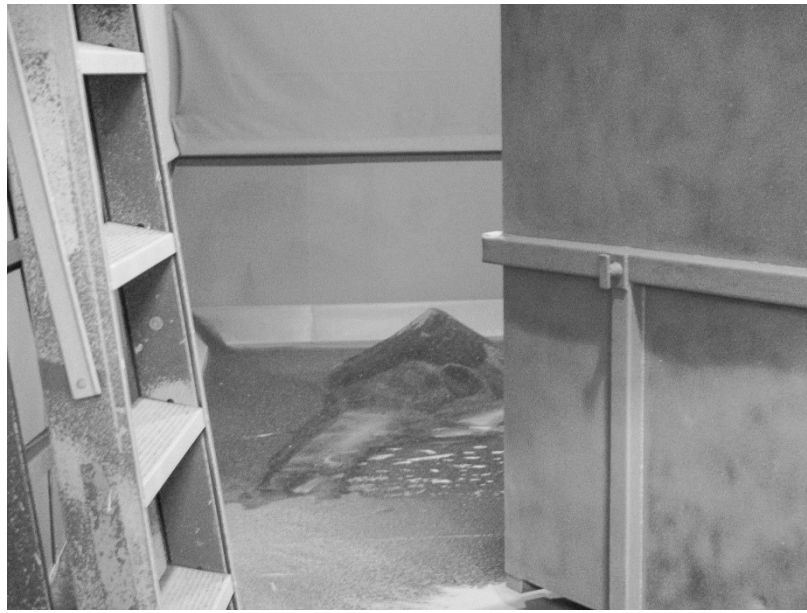
Meetlocatie 3: Hoop opgeschept gebruikt straalgrit achterin de straalcabine
