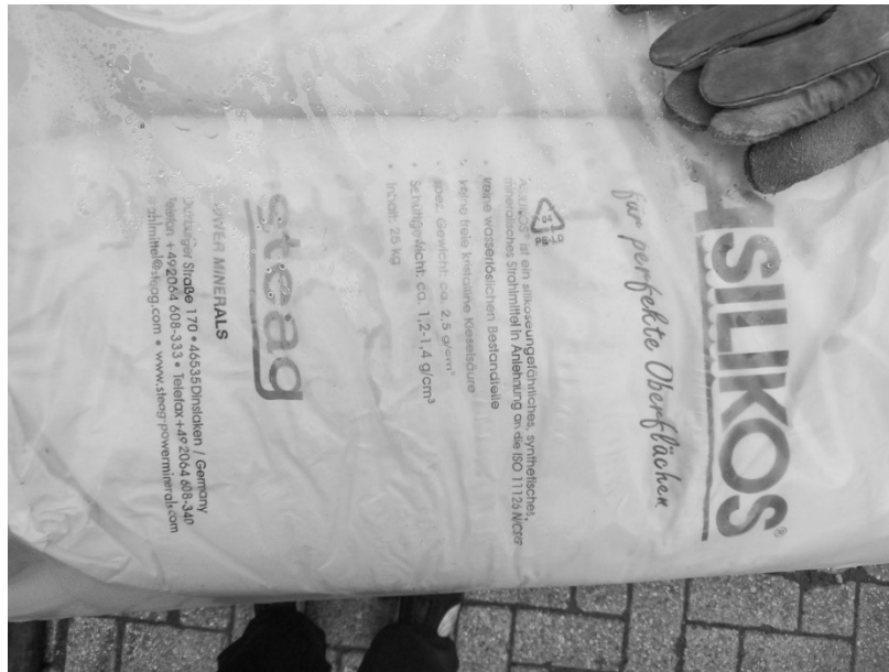
Meetlocatie 1B: Asilicos aluminiumsilicaat straalgrit in zakken, zoals gebruikt tijdens deel van de vulwerkzaamheden
