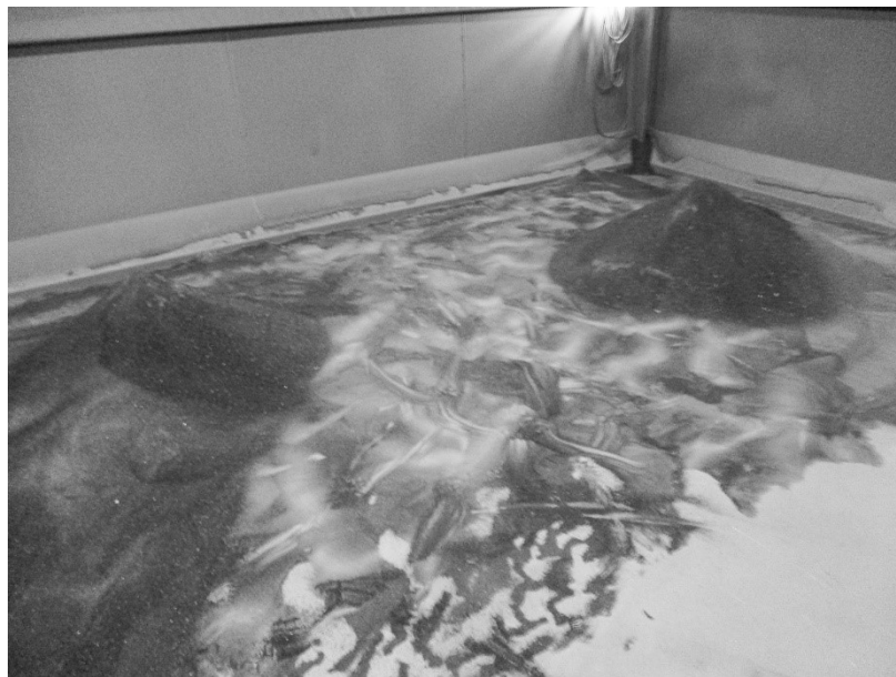
Meetlocatie 3: Hoopjes opgeschept gebruikt straalgrit achterin de straalcabine
