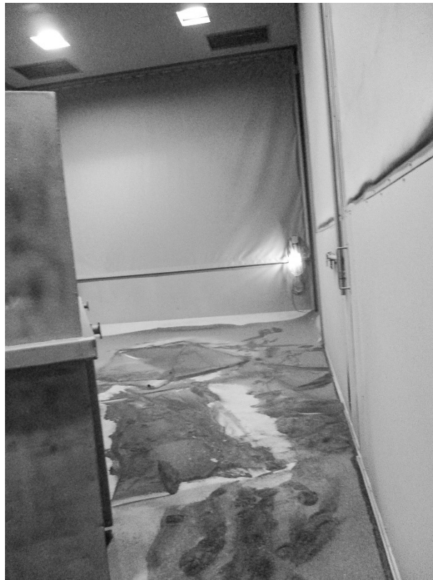
Meetlocatie 3: Gebruikt straalgrit op de vloer van de straalcabine
