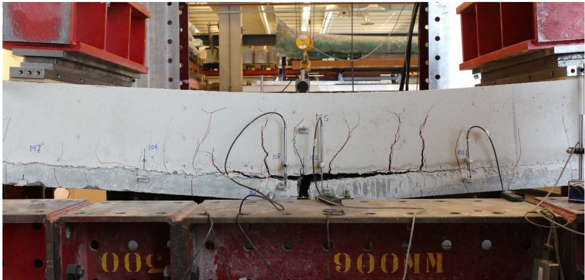
foto 17 Bezwijken door vloeien van staal van de koppelwapening (proefstuk 42 - R2)
