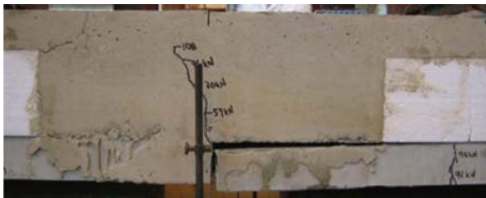
foto 10 Bezwijkbeeld proefstuk 5 (zonder tralieligger naast de naad) [24]
