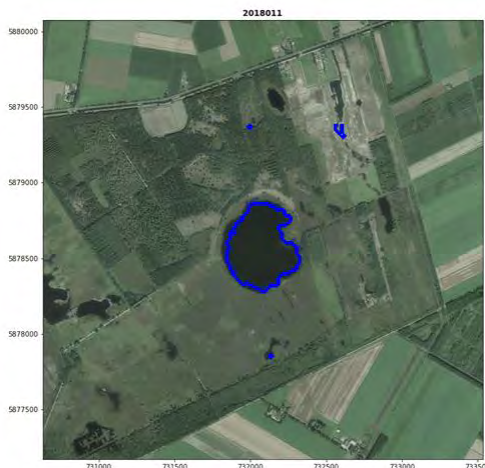
Figuur 21: Open water detectie via remote sensing. Open water - ven in gebied Fochtelooerveen.
