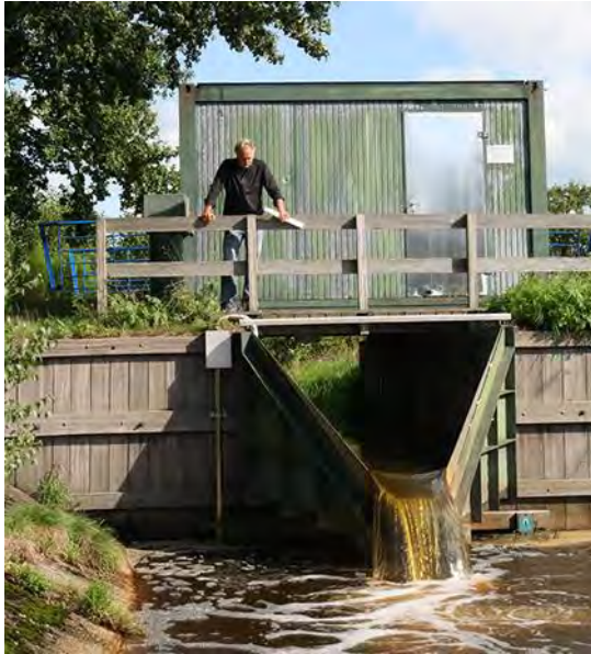
Figuur 14: Hupselse Beek, afvoerm Meetpunt Stuw 10A (WRIJ) met geijkte H-flume.
