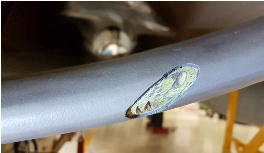
Figuur 11 Inslagschade op de lip van de motorinlaat na verwijdering van de rubberen coating (bron: NLR).
