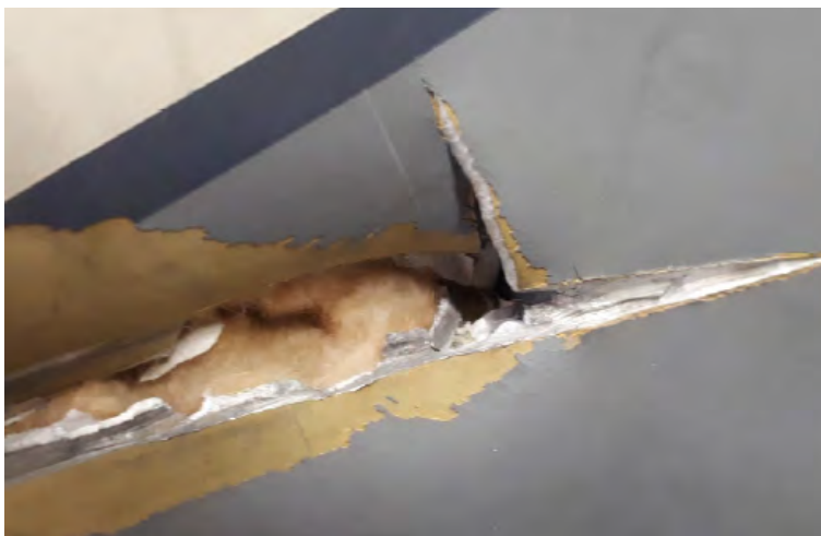
Figuur 13 Detailopname van inslag C op de vliegtuighuid (bron: IVD).
