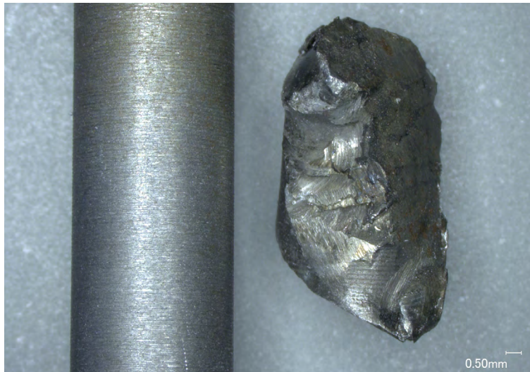
Figuur 12 Een deel van een intacte pin (links) en het teruggevonden deel in de oliekoeler (rechts) (bron: NLR).
