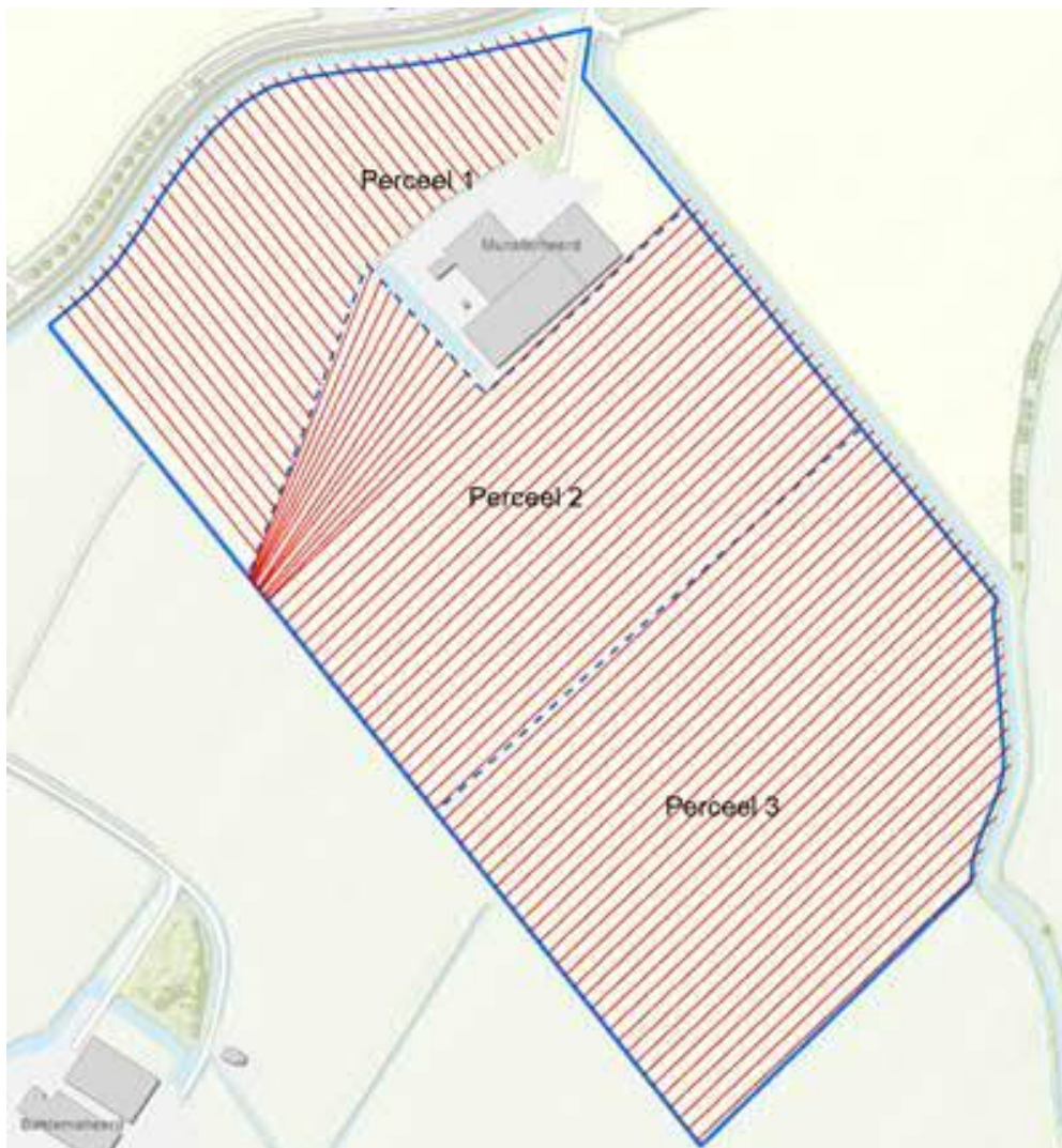
Fig. 3.10 Ligging drains uitgaande van een h.o.h. afstand van 8 m (op perceel 3 liggen drains uit 2014 en 1996, de drainafstand is op dit perceel 4 m)
