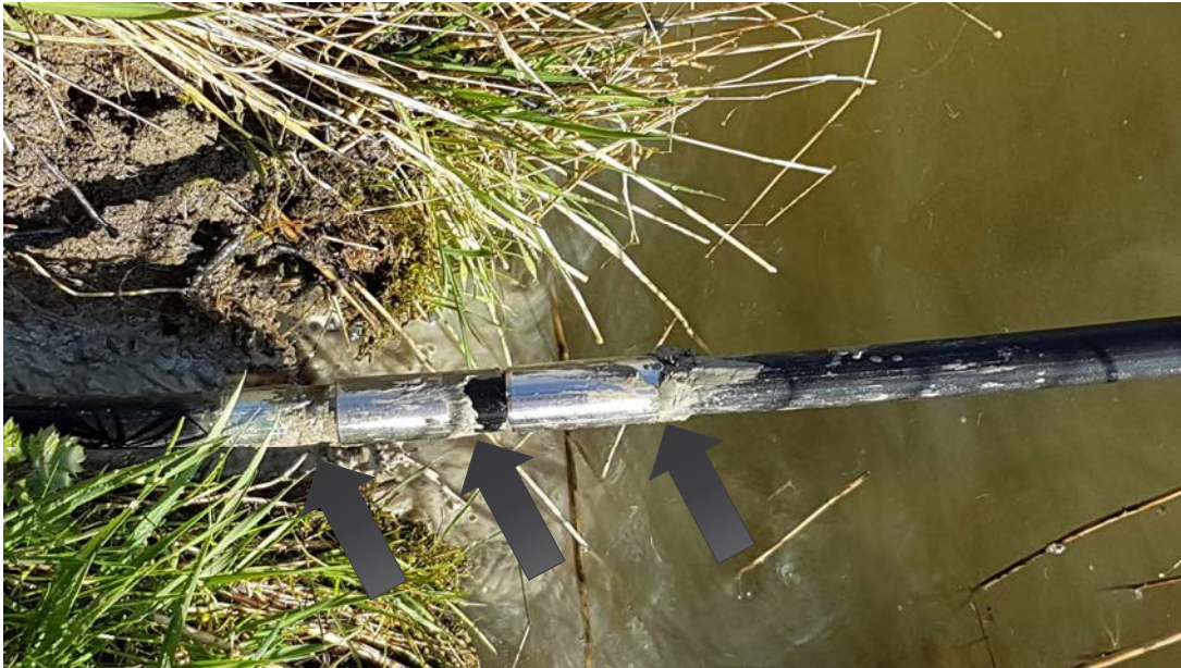
Fig. 3.7 Klei- slibresten op de slang van de drainreiniger
