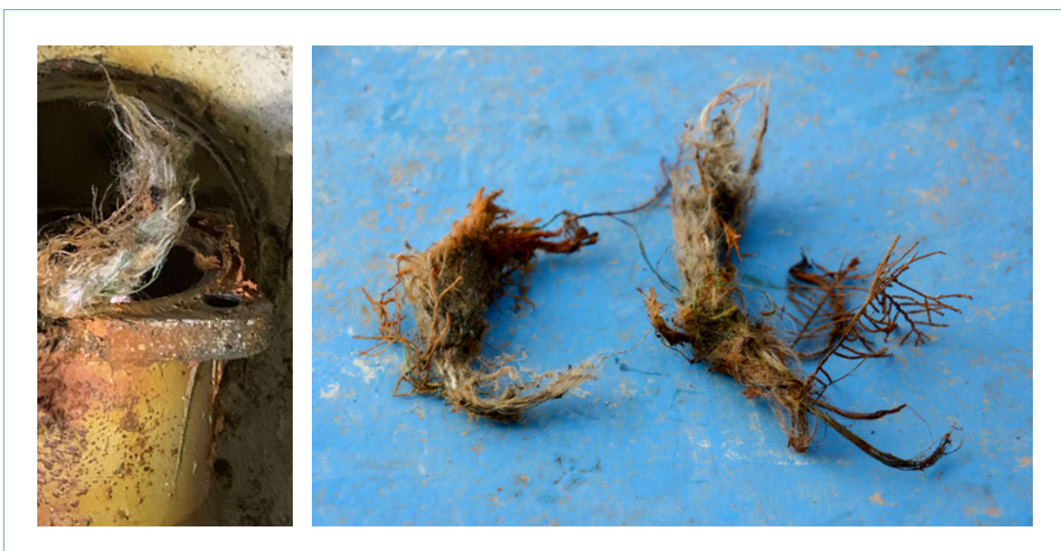
Figuur 20: Touwwerk in stuurboord lensuitlaat. (Bron: Nationale Politie)
