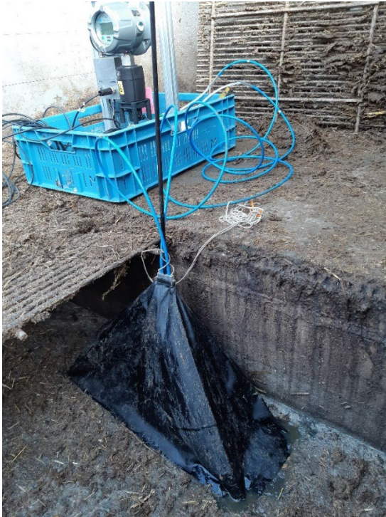
Figuur 10 Omgekeerde paraplu voor het meten van de ammoniakproductie uit de mest. Het voordeel van de paraplu is dat deze door de roosterspleten gestoken kan worden. In dit geval is het rooster er afgehaald.
