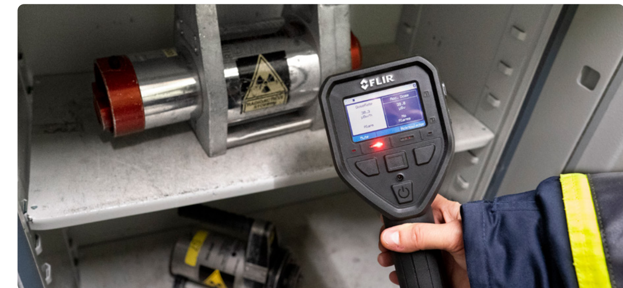
Meten van ioniserende straling aan de buitenkant van een bronhouder, met daarin een radioactieve bron voor industriële radiografie.
