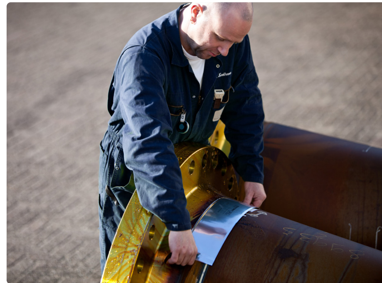
Een werknemer bereidt niet-destructief onderzoek met ioniserende straling voor.
