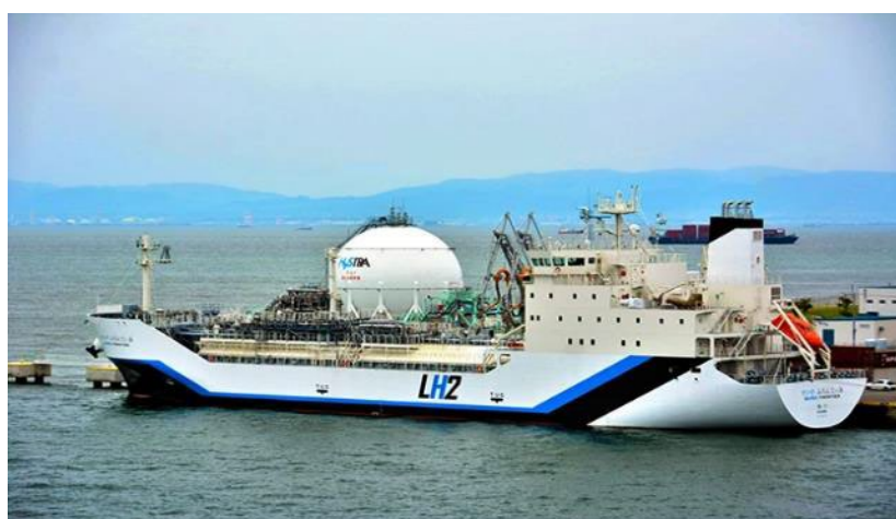
Afbeelding 3.3 Het eerste schip ter wereld dat vloeibaar waterstof kan vervoeren is in 2021 in Japan gebouwd en kan 75 ton H 2 vervoeren. Het gaat om een experimenteel schip.
