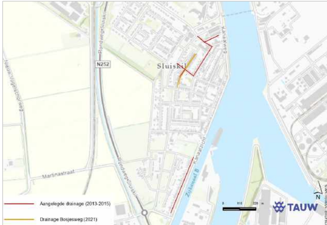
Figuur 2.7 Drainage die naast de bestaande riolering is aangelegd in Sluiskil
