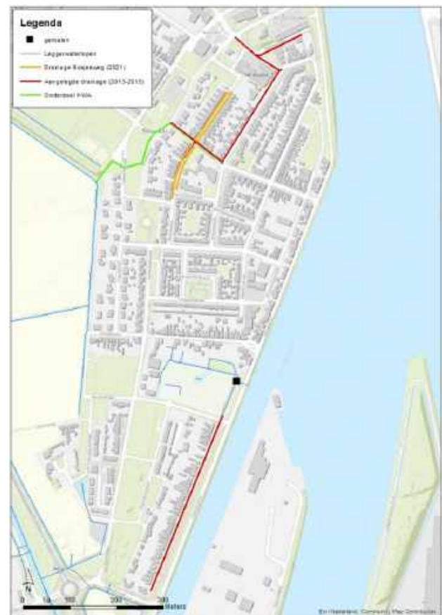
Figuur 3.27 Drainage die naast de bestaande riolering is aangelegd in Sluiskil
