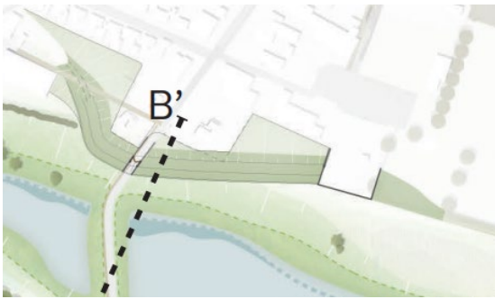
Figuur 3-18: Steilranddijk met coupure met verhoogde drempel bij De Paad Oost
