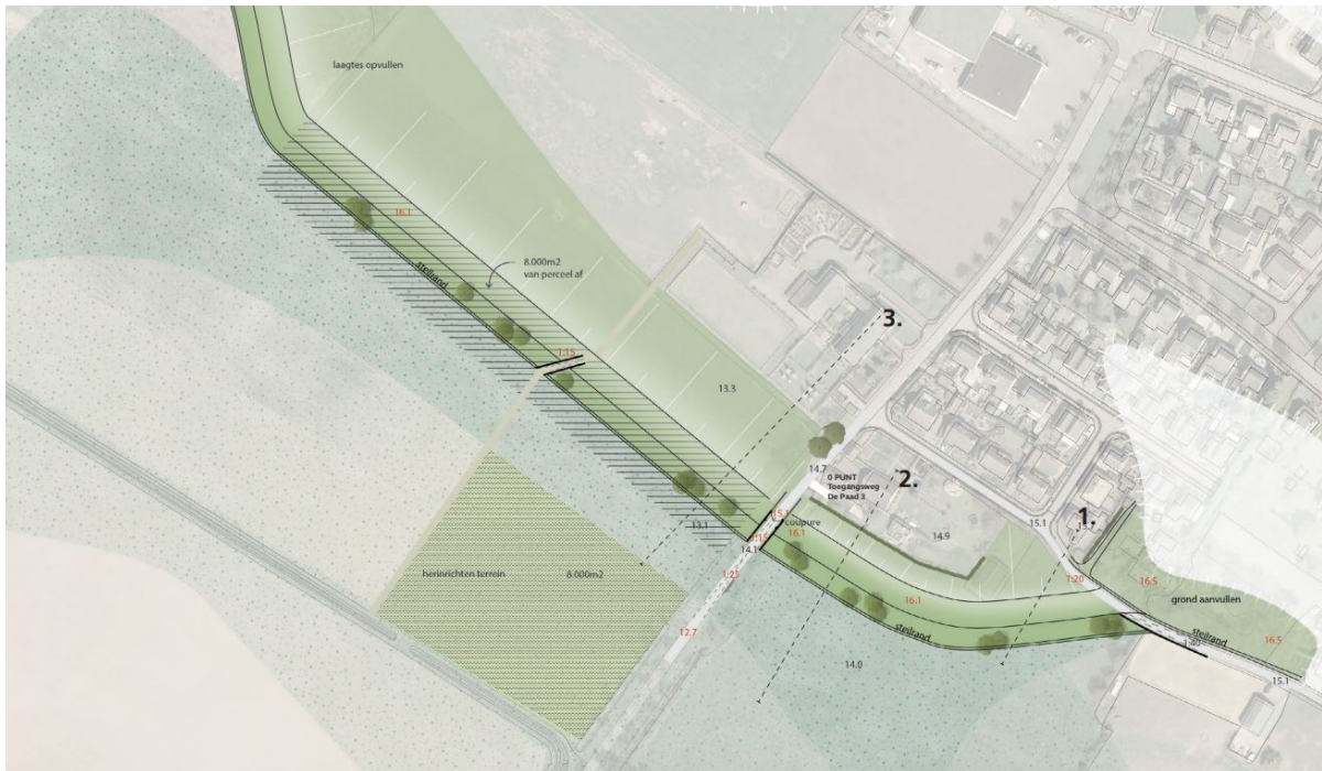
Figuur 3-21: Steilranddijk met coupure met verhoogde drempel bij De Paad west
