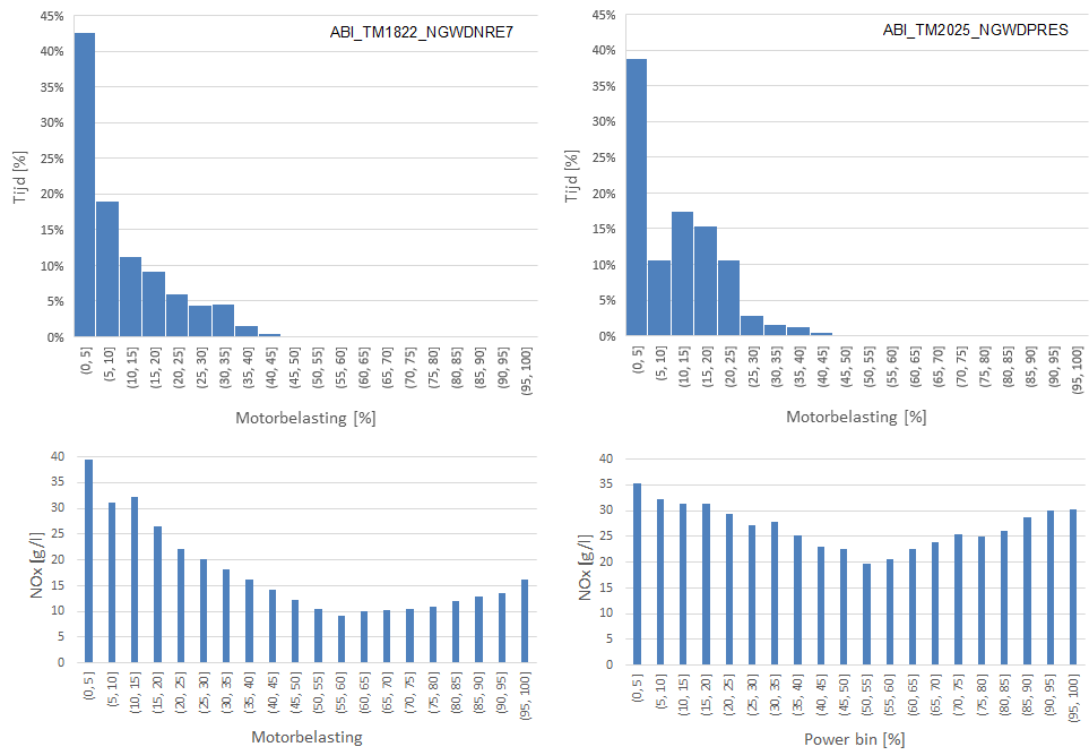
Figuur 9: Tijdsverdeling en NOx emissies in gram per liter brandstof per motorbelasting van de Stage V heimachine "ABI_TM1822_NGWDNRE7" (links) en de oudere heimachine "ABI_TM2025_NGWDPRES" (rechts).
