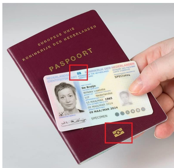
Figuur 8: NFC chips Nederlands paspoort en identiteitsbewijs (bron afbeelding: [privacy-web.nl] )
