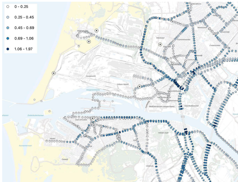
Figuur 34 Bijdragen van wegverkeer aan de PM_{10} -concentraties ( \mu\text{g}/\text{m}^3 ) in de IJmond in 2021 (De Smet et al. 2022).
