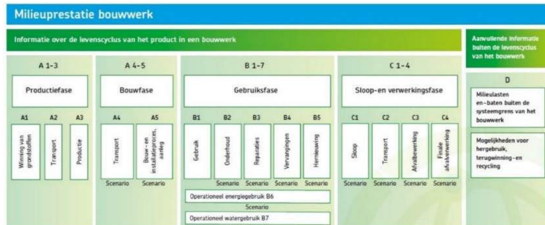
Figuur 3 | Opbouw Milieuprestatie Bouwwerk
