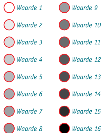
Afbeelding 2.1 Voorafgaand aan het scannen wordt een OMR-apparaat gekalibreerd, waarbij ingesteld wordt welke waarde tussen 1 (wit) en 16 (zwart) als '0' en welke als '1' moet worden weggeschreven.
