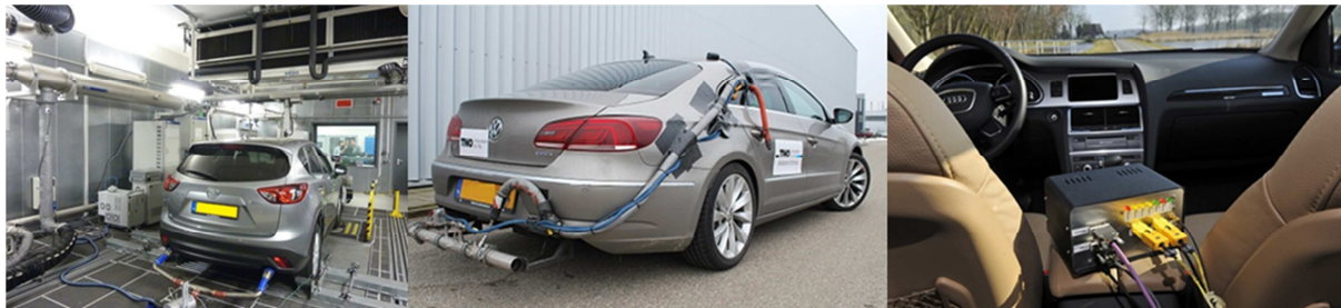
Figuur 6 - Metingen aan voertuigen in het lab (links) en op de weg met PEMS (midden) en met SEMS (rechts)
