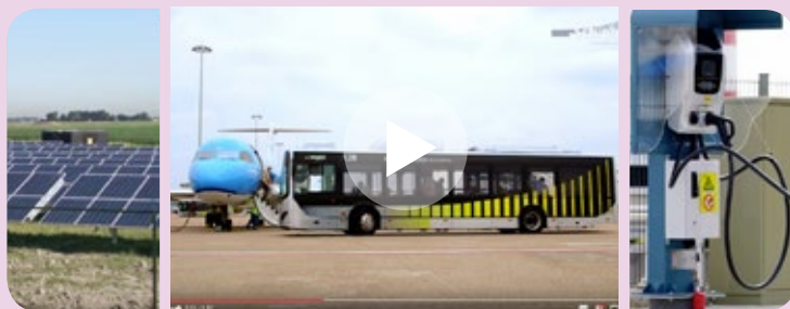
Sinds kort rijden op Schiphol 35 elektrische bussen om passagiers tussen de terminal en vliegtuig te vervoeren. De energie voor de bussen wordt opgewekt via een eigen veld met zonnepanelen.
