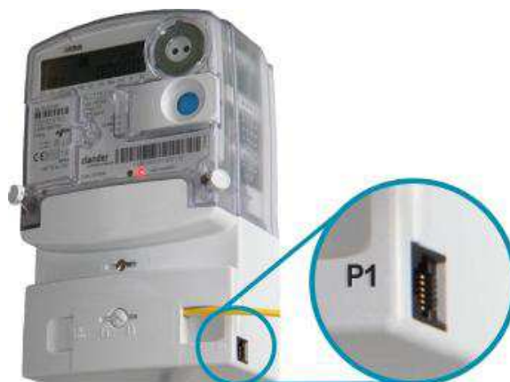
Afbeelding 2: voorbeeld consumentenpoort (P1-aansluiting) voor directe uitleesmogelijkheden
