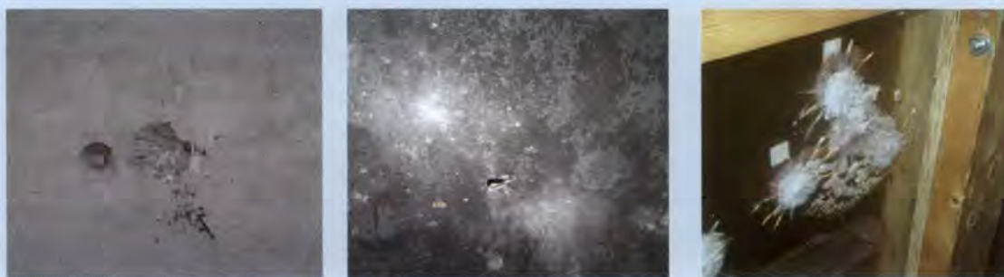
Figuur 12: Enkele afbeeldingen van door de Politie op doorschot geteste materialen. (Foto's: Politie-academie)
