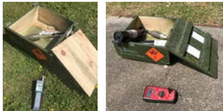
Figuur 27 Temperatuurmeting binnen- en buitenzijde lege stalen mantel (links) en op de TNT gevulde mantel en inerte schokbuis van de HE80 mortiergranaat (rechts).
