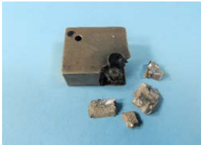
Figuur 27 Schade aan het messing blokje na detonatie van het duplex slagpijpe.
