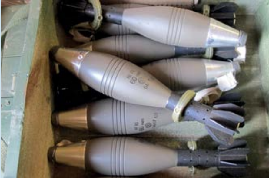
Figuur D2: De kist met acht onverpakte granaten in de munitieopslag van Kamp Nassau te Kidal, zoals aangetroffen door de Commissie van Onderzoek van Defensie. Twee granaten liggen met de punt (schokbuis) naar rechts georiënteerd; dit zijn waarschijnlijk de twee granaten die, voorafgaand aan de vierde serie, uit de vierde kist zijn gehaald en bij de zes granaten in de derde kist zijn gevoegd. (Bron: CvO Defensie)
