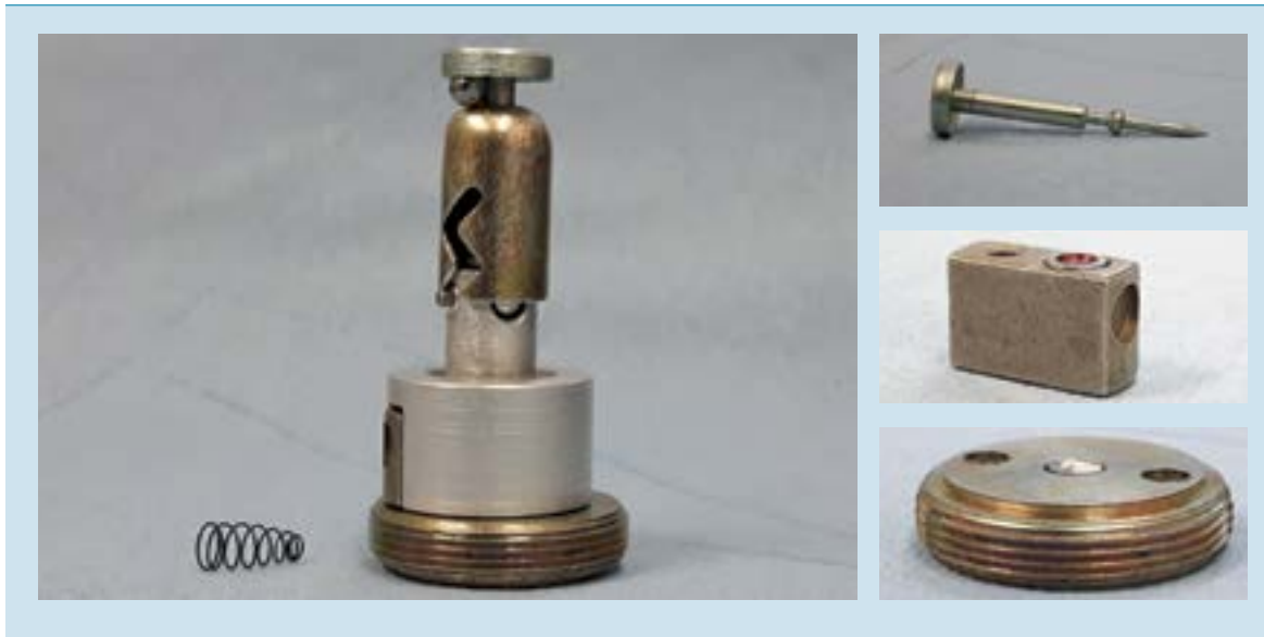
Figuur C6: Links een huis met deels zichtbare sluiters en setback-kogel, de terugslagkap met daaronder een (niet zichtbare) veer en de setback-kogel tussen de terugslagklep en slagpinbegrenzer; het geheel is gepositioneerd op de afsluitplaat, met links de sluitveer. Rechtsboven: slagpin, rechtsmidden: sluiters met initiatielading aan de rechterbovenkant en uitsparingen voor de slagpinblokkering aan de linkerbovenkant en voor de sluitersveer aan de rechterzijkant. Foto rechtsonder: onderkant van een afsluitplaat met overdrachtslading in het midden en twee openingen die dienen voor assemblage. (Bron: Defensie).
