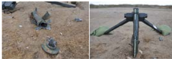
Figuur 21 Schietbuis na een inwendige detonatie (links) en deflagratie (rechts) van een 60 mm mortiergranaat [ref. 10].
