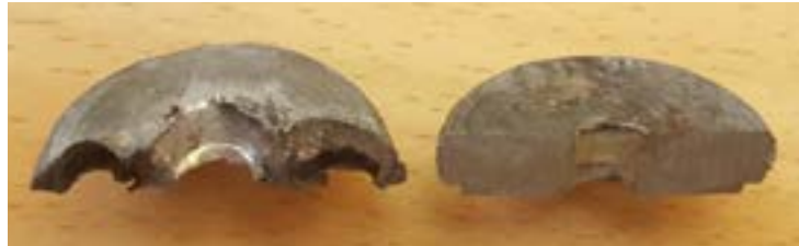
Figuur 11 Bovenzijde van de afsluitplaat uit de test in gewapende stand (links) en die van het ongeval (rechts). De afsluitplaat uit de test in gewapende stand is gebroken als gevolg van de detonatie, de afsluitplaat uit het ongeval is in zijn geheel teruggevonden, maar is doorgezaagd voor nader onderzoek.
