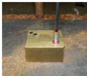
Figuur 26 Detcord met booster geplaatst op de bovenzijde van het duplex slagpijpje dat verzonken is in messing blok.
