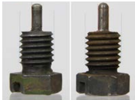
Figuur 4 Vergelijk beide slagpinnen (links: referentie, rechts: ongeval).
