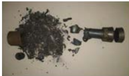
Figuur 20 Schadebeeld aan een afgesloten buis na een detonatie (links) en deflagratie (rechts).
