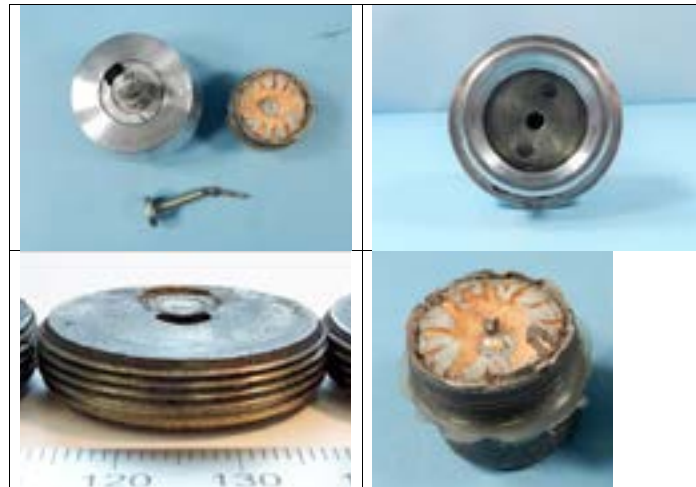
Figuur 13 Enkele foto's van experiment 4, van linksboven met de klok mee: schokbuis na het experiment; onderzijde afsluitplaat met restant cupje overdrachtslading; afdruk bodem cupje overdrachtslading in schokversterker; doorgeslagen afsluitplaat met indeuking ter plaatse van duplex slagpijpje.
