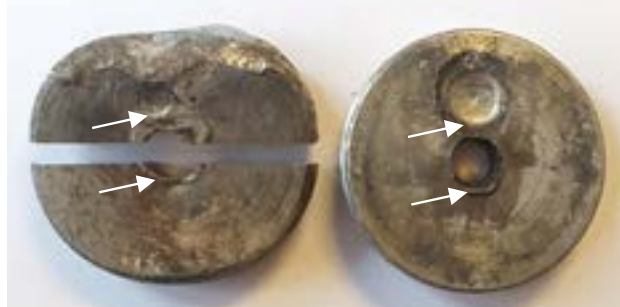
Figuur 16 Vergelijk tussen de afsluitplaat van de schokbuis van het ongeval (links) en de afsluitplaat uit de schokbuis van experiment 3 (rechts).
