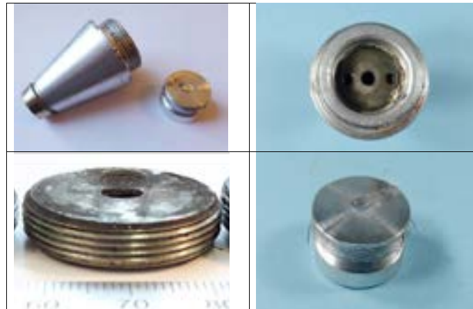
Figuur 11 Enkele foto's van experiment 2, van linksboven met de klok mee: schokbuis na het experiment; onderzijde afsluitplaat; afdruk aluminium dop; doorgeslagen afsluitplaat met indeuking ter plaatse van duplex slagpijpje.
