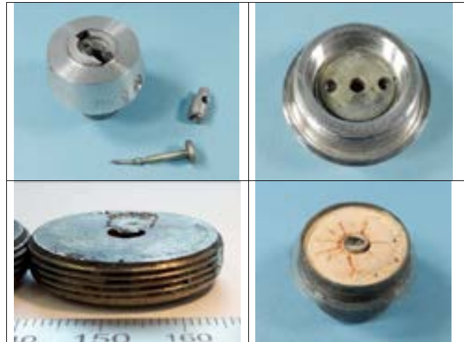
Figuur 14 Enkele foto's van experiment 5, van linksboven met de klok mee: schokbuis na het experiment; onderzijde afsluitplaat met restant cupje overdrachtslading; afdruk bodem cupje overdrachtslading in schokversterker; doorgeslagen afsluitplaat met indeuking ter plaatse van duplex slagpijpe.
