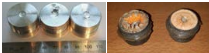
Figuur 17 Uitwerking op boosters met van links naar rechts experiment 1 t/m 5. Drie aluminium doppen als inerte booster in linker foto en twee originele boosters in rechter foto.
