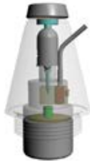
Figuur 1 Positionering van het detonatiekoord in de schokbuis M6-N.
