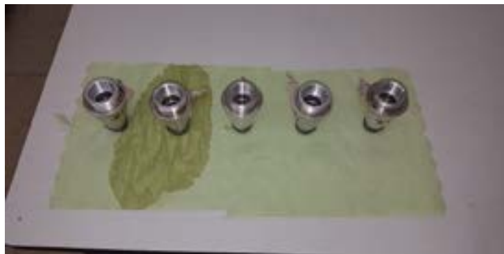
Figuur 8 De lijmlaag van één van de vijf M6-N schokbuis behuizingen is lek na een vijftal valtesten vanaf ongeveer 1 m hoogte en willekeurige impact oriëntatie met de grond.
