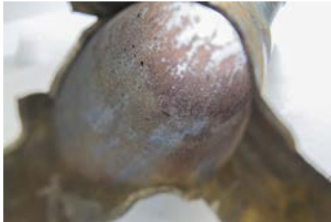
Figuur 24 Enkele kleine onregelmatigheden aan de binnenzijde van de restanten van schietbuis No. 513 na het ongeval.
