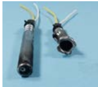
Figuur 24 Uitwerking van het detcord zonder booster (links) en met booster (rechts), geplaatst tegen de bodem van een C2 ontsteker.
