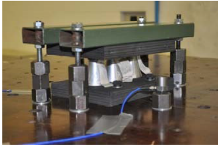
Foto 13 Opstelling triltafel Sinus-Sweep
