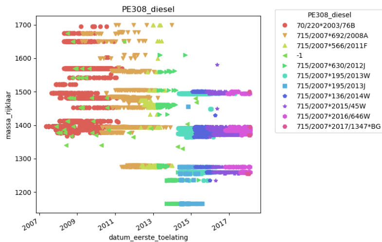
Figuur 10 Massa rijklaar van het model Peugeot 308 uitgezet tegen bouwjaar en onderverdeeld naar typegoedkeuringscode.
