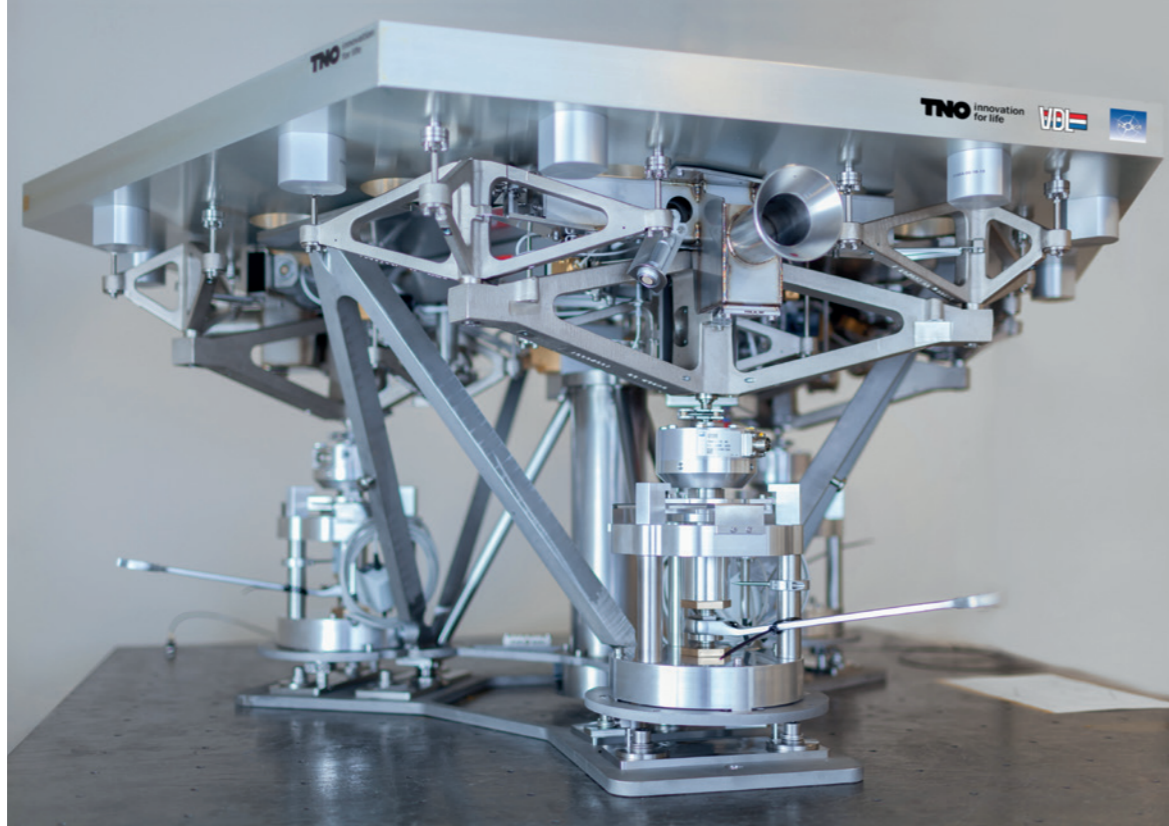
Draagconstructie voor spiegelsegmenten voor de Europese Extreme Large Telescope (E-ELT; VDL, TNO, NOVA, ESO)
