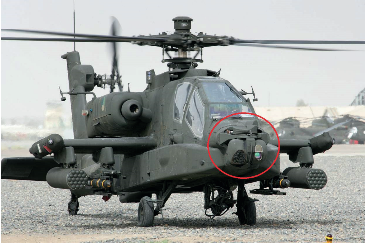
Figuur 6: Positie PNVS en (M)TADS op de neus van de Apache-helikopter (rode cirkel). (Bron: www.defensie.nl )
