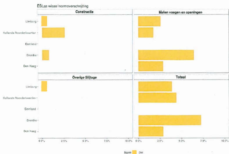
Figuur 6. Het percentage normoverschrijdingen bij het object ESlas-wissel voor de vijf contractgebieden uitgesplitst naar het aspect van de geconstateerde bevinding. Het totaal is de som van de geconstateerde normoverschrijdingen over alle aspecten.
