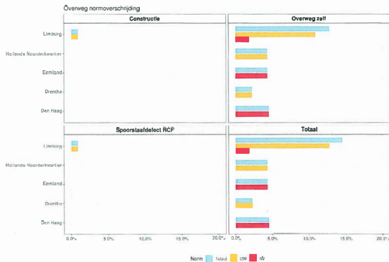
Figuur 4. Het percentage normoverschrijdingen bij het object overwegen voor de vijf contractgebieden uitgesplitst naar het aspect van de geconstateerde bevinding. Het totaal is de som van de geconstateerde normoverschrijdingen over alle aspecten.
