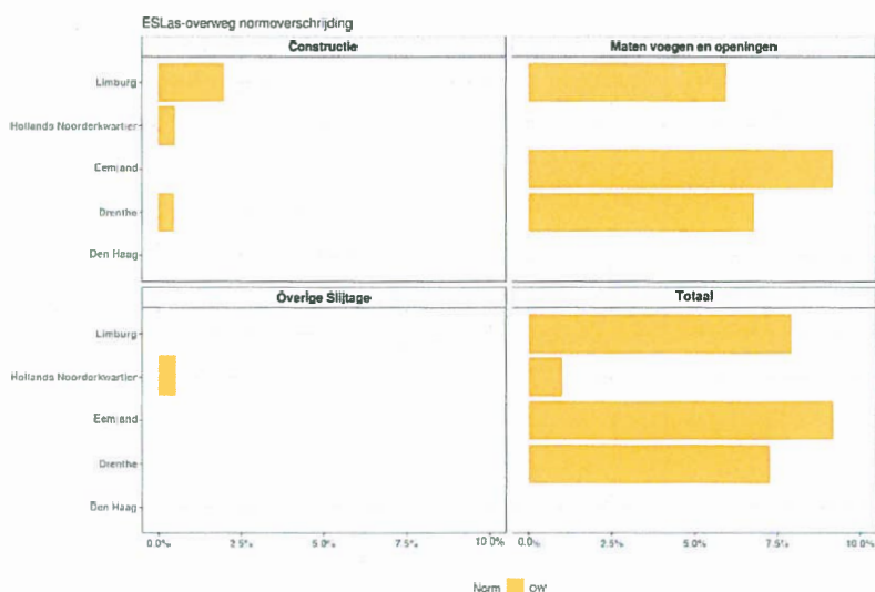
Figuur 7. Het percentage normoverschrijdingen bij het object ES-lasoverweg voor de vijf contractgebieden uitgesplitst naar het aspect van de geconstateerde bevinding. Het totaal is de som van de geconstateerde normoverschrijdingen over alle aspecten
