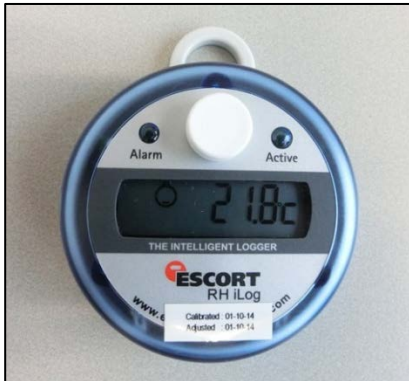
De Escort iLog met display, indicatielampjes en wit beschermkapje over de sensoren
