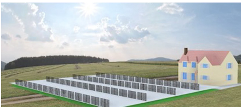
Figuur 16 Mogelijkheden bifacial verticale zonnepanelen, Bron: RVO-prijsvraag zonnestroom, https://www.youtube.com/watch?v=DQdzRsC3qTU .
