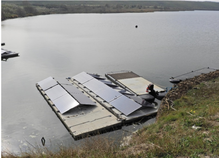
Figuur 21 Proefopstelling drijvende zonnepanelen in de Slufter, 2 e Maasvlakte (foto: Friso van der Zee).
