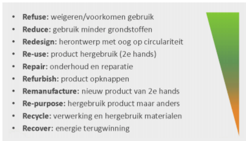
Figuur B2.4: Overzicht van het 10R-model van Cramer voor circulariteit [Bastein en Rietveld, 2016]
