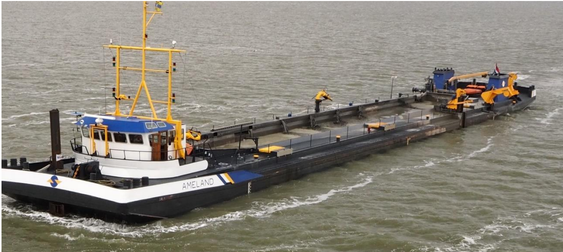
Figuur 5: Sleephopperzuiger "Ameland" ligt de hele werkweek in de vaargeul Holwerd-Ameland te baggeren.
