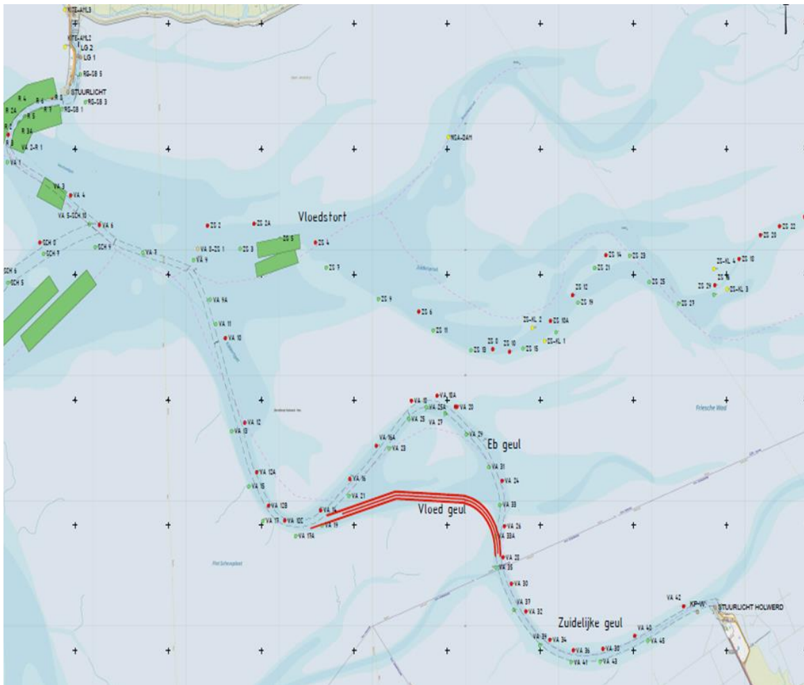
Figuur 7: Vaargeul Holwerd-Ameland met vaargeulmarkering (situatie feb 2018), de locatie van de vloedgeul (rode lijn) aangelegd in januari 2019, en de locaties van verspreidingsvakken (groene vakken)
