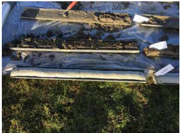
Foto 30 - Plaatsing peilbuis 103 (8 - 11 m-mv), in traject 10 - 11 m-mv is granuliet zichtbaar
