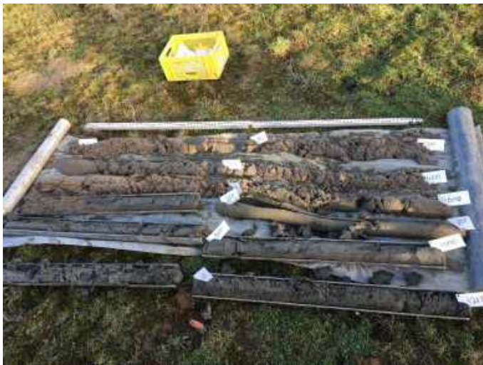
Foto 25 - Plaatsing peilbuis 102 (0 - 12 m-mv)
