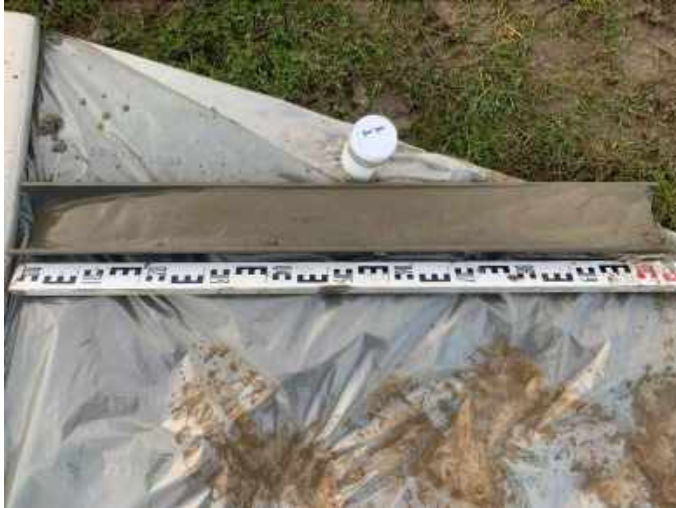
Foto 19 - Plaatsing peilbuis 101 (8 - 9 m-mv)
