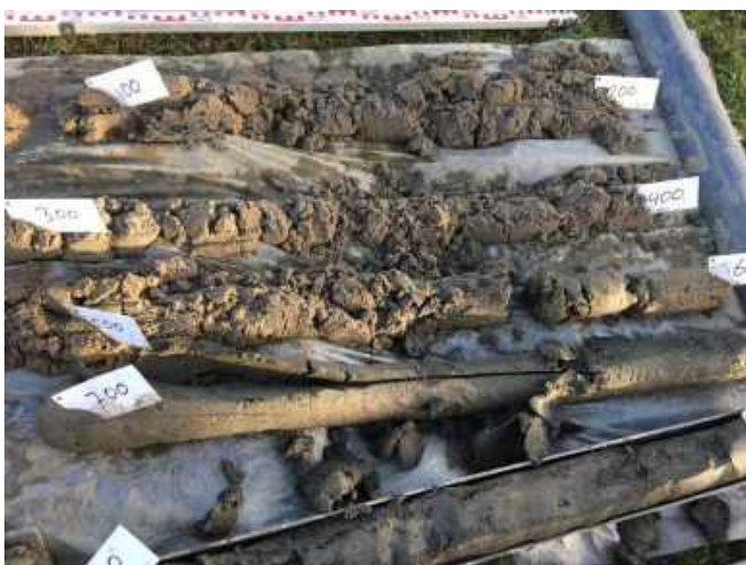
Foto 23 - Plaatsing peilbuis 102 (0 - 7 m-mv)
