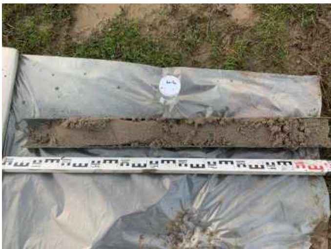
Foto 17 - Plaatsing peilbuis 101 (6 - 7 m-mv)
