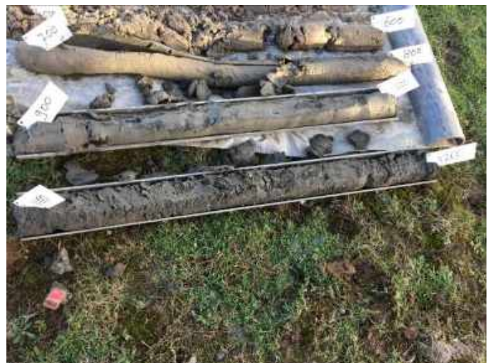
Foto 24 - Plaatsing peilbuis 102 (7 - 12 m-mv)
