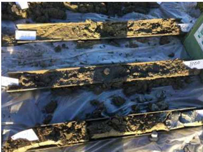
Foto 29 - Plaatsing peilbuis 102 (5 - 10 m-mv)
