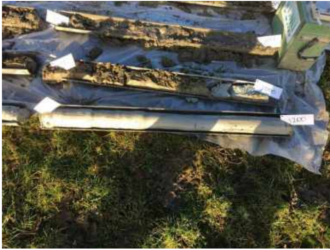
Foto 31 - Plaatsing peilbuis 103 (7 - 12 m-mv), in traject 11 - 12 m-mv is granuliet zichtbaar
