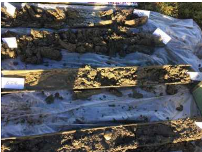
Foto 27 - Plaatsing peilbuis 103 (1 - 6 m-mv)
