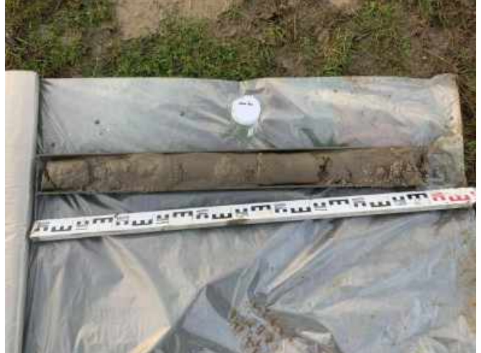
Foto 16 - Plaatsing peilbuis 101 (5 - 6 m-mv)
