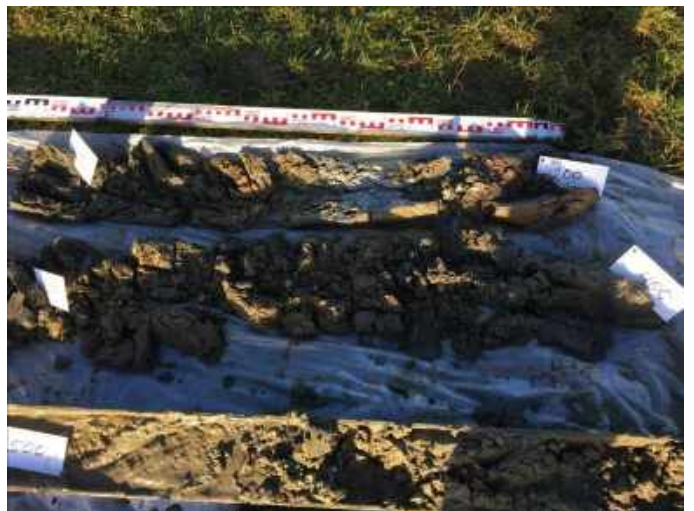
Foto 28 - Plaatsing peilbuis 103 (1 - 6 m-mv)
