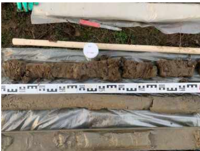
Foto 11 - Plaatsing peilbuis 101 (0 - 1 m-mv)
