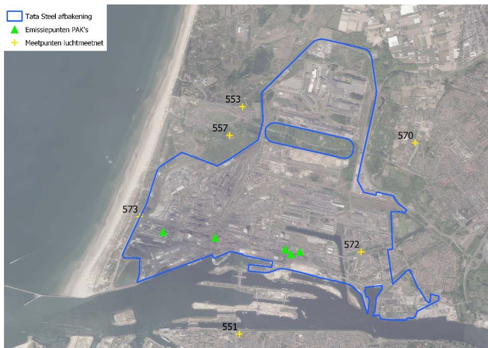
Figuur 3.8 Ligging van emissiepunten waar één of meerdere soorten PAK worden uitgestoten. Achtergrond: luchtfoto Actueel Ortho HR (Kadaster, www.pdok.nl , 2021), Tata Steelterrein (IBIS, 2020)
