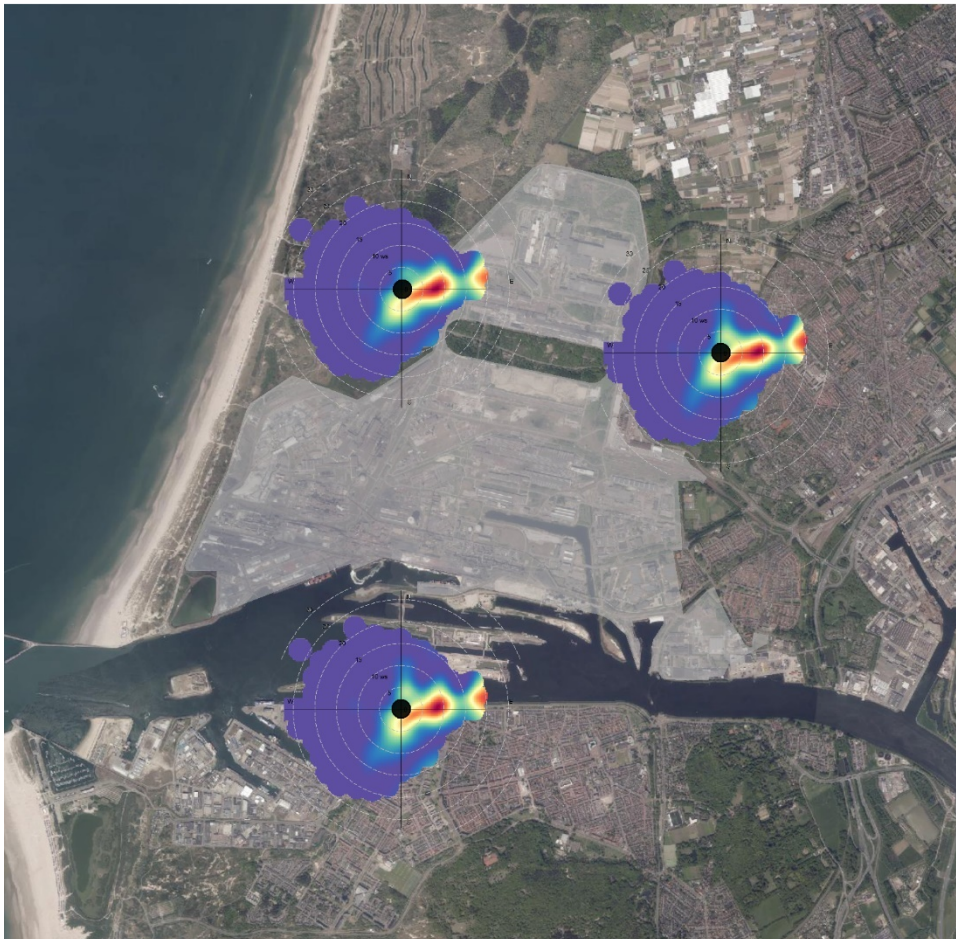
Figuur B1.4 CBPF-windanalyse voor het nitraatrijk en sulfaatrijk profiel. Achtergrond CBPF: Luchtfoto Actueel Ortho HR (Kadaster, www.pdok.nl , 2021) CC BY 4.0. Tata Steelterrein (IBIS, 2020)
