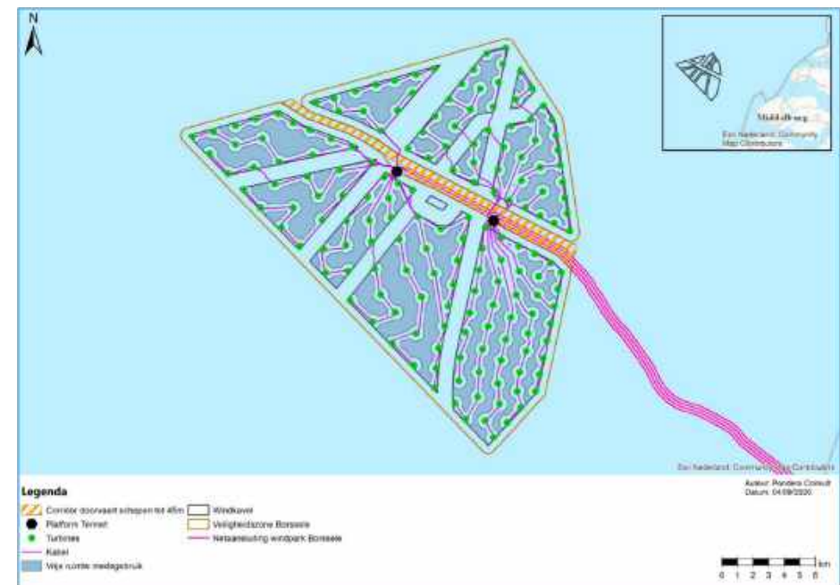
Figuur 10-b: De beschikbare ruimte voor potentieel medegebruik in Windenergiegebied Borssele (9.800 hectare)
