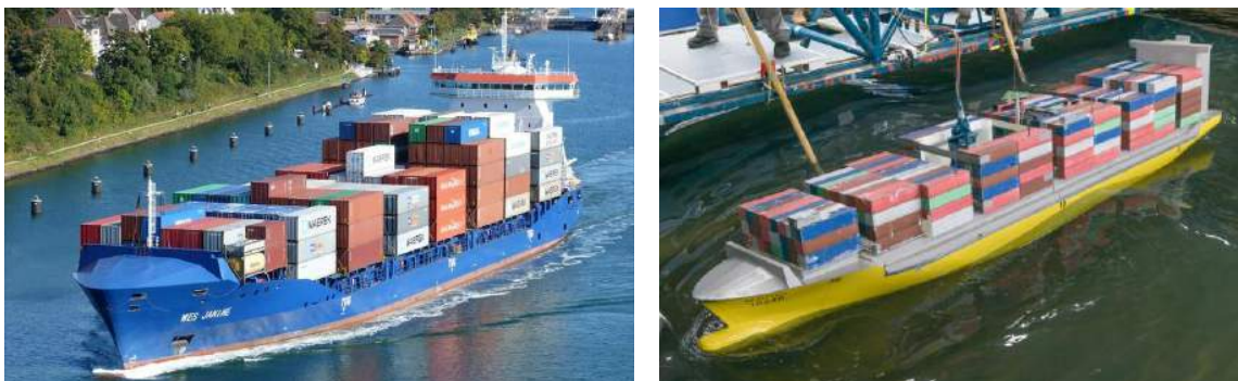
Links: Typische Feeder van deze lengte met veel voorkomende container configuratie Rechts: MARIN model van een Feeder voor huidige modelproeven
