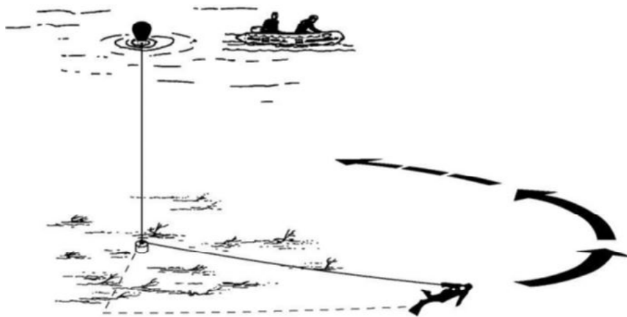
Afbeelding 5 De cirkelvormige zoekmethode (Bron: VKM 007 Arbeid onder overdruk, deel 5 Onderwatersearch, conceptversie).
