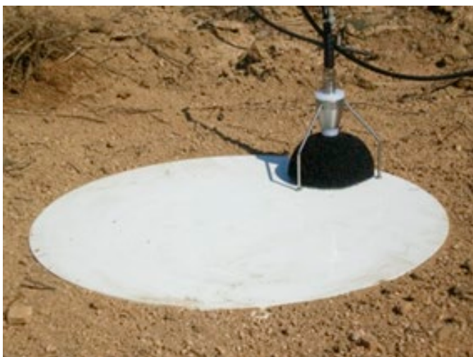
Figuur 6: Microfoonopstelling waarbij de microfoon ondersteboven op een grondplaat wordt geplaatst (inverted ground-plane microphone of IGPM)
