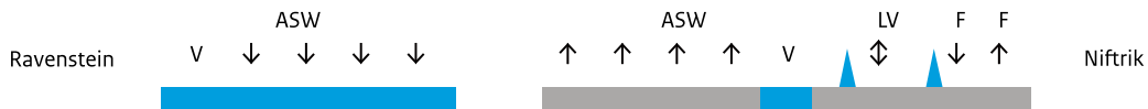
Figuur 8: Alternatief 10; indeling ter hoogte van de Maasbrug (V=vluchtstrook, ASW = autosnelweg, LV = langzaam verkeer, F = fietsverkeer)
